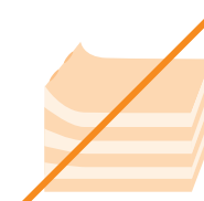
Papier zu dünn – Klammerung trägt auf
